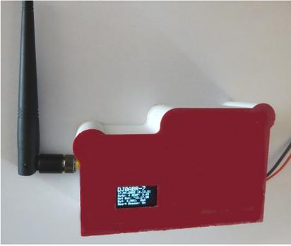
Bild 8: der fertige 1-Watt Tracker (Dateiname: tracker.png)
