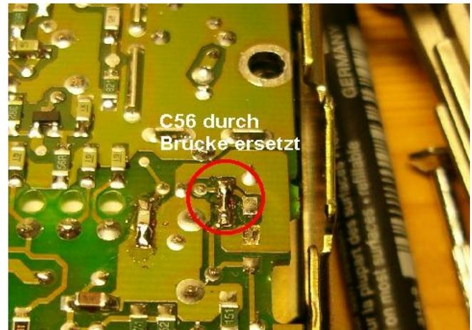
Abbildung 27: C56 durch Brücke ersetzt
