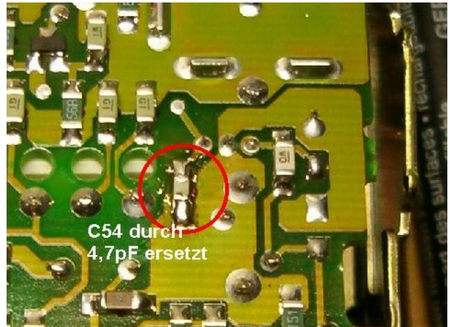
Abbildung 25: C54 durch 4,7 pF Keramik-C ersetzt
