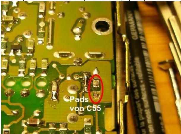
Abbildung 28: Position der Lötunkte für C55
