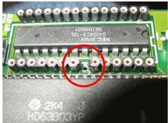
Abbildung 3: Pin und Plastik entfernt
